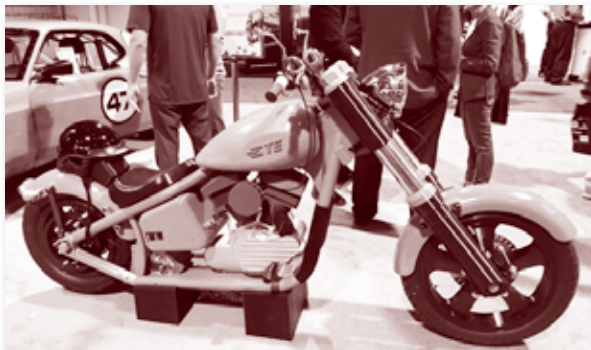
รถจักรยานยนต์ทำจากการพิมพ์สามมิติ โดยใช้พลาสติก ABS พลาสติก Ultem และสัมฤทธิ์ (Bronze)
