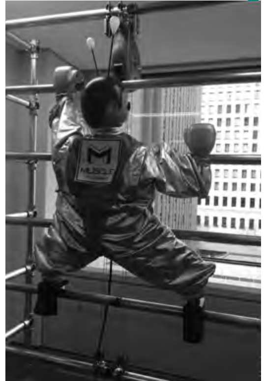
Yume Robo รุ่นยนต์เพื่อการก่อสร้าง
